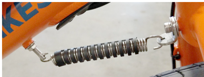
Deflopilator volledig geïnstalleerd
