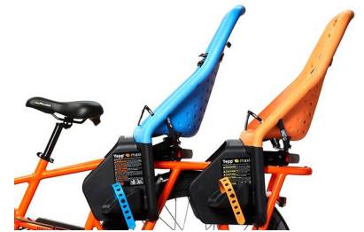
Bagagedrager met twee geïnstalleerde optionele Thule Yepp-zitjes
