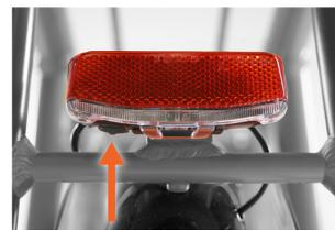
Die Blitzfunktionstaste befindet sich unten links am Rücklichtgehäuse.
