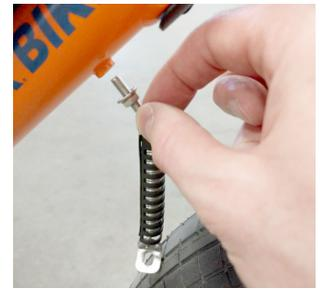
Die Ringschraube des Deflopilators mindestens 5 mm in das Unterrohr einschrauben. Mit Kontermutter sichern.
