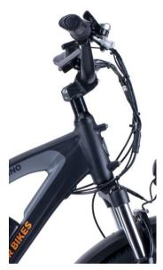
D. **Ziehen Sie sie mit dem empfohlenen Anzugsmoment fest.** Nach erfolgter Einstellung können Sie die vier Lenkerklemmplattenschrauben (siehe Abbildung rechts) mithilfe eines Drehmomentschlüssel und eines 5 mm-Inbuseinsatzes gleichmäßig mit dem empfohlenen Anzugsmoment von 10 Nm festziehen.
