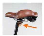
Halten Sie den Sattel in der gewünschten Position und ziehen Sie die Satteleinstellschraube mit einem 6 mm Sechskantschlüssel sicher fest.
