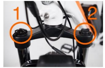
Vorspannungseinstellknopfs mit dem Uhrzeigersinn in Richtung des kleinen "+"-Symbols erhöht werden.
