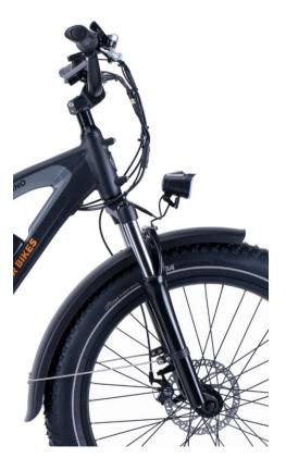
E. **Stellen Sie den Scheinwerferwinkel** so ein, dass die Straße ausleuchtet wird, ohne den Gegenverkehr zu blenden. Lösen Sie wenn nötig die Scheinwerferwinkeleinstellschraube mit einem 3 mm Inbusschlüssel und einem 8 mm Schraubenschlüssel, neigen Sie den Scheinwerfer in die optimale Position und ziehen Sie ihn in dieser Position vorsichtig wieder fest.
