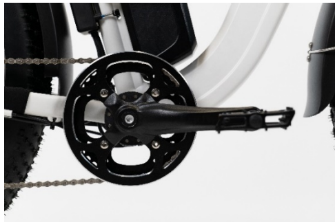
La pédale droite (1) se serre dans le sens des aiguilles d'une montre
