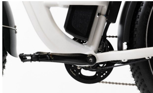
La pédale gauche (2) se serre dans le sens contraire des aiguilles d'une montre
