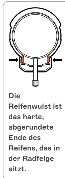
Überprüfen Sie die Seiten der Reifen, verwenden Sie die Linien und Markierungen darauf als Referenz, um sicherzustellen, dass die Reifenwulst vollständig und gleichmäßig in die Felge eingeführt ist.
