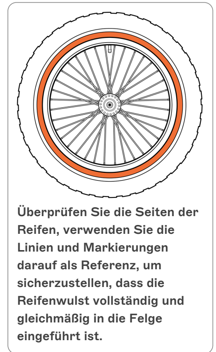
Die Reifenwulst ist das harte, abgerundete Ende des Reifens, das in der Radfelge sitzt.
