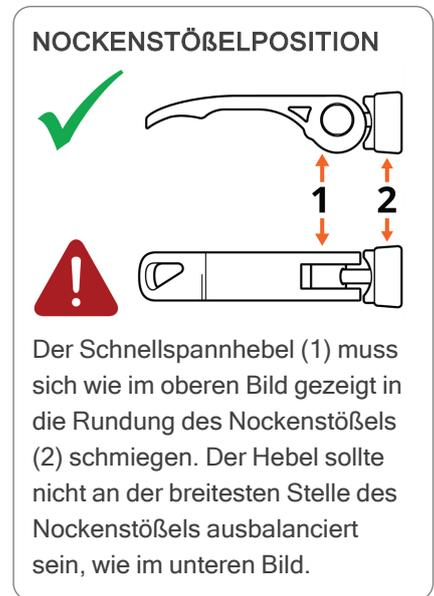
**HINWEIS:** Die Sicherheit und Stabilität Ihres Vorderrads hängt von einer sehr straffen Klemmkraft des Schnellspannhebels ab. Bei einem richtig eingestellten Schnellspannhebel erfordert das Öffnen und Schließen einen hohen Kraftaufwand.
