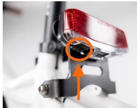
Pour activer le mode de clignotement, mettez le vélo et le feu arrière sous tension en suivant les instructions ci-dessus, puis, descendez du vélo et appuyez sur le bouton en caoutchouc du mode flash situé sur le côté inférieur gauche du boîtier du feu (entouré ci-dessus) En mode de clignotement, l'activation des freins donne un éclairage continu plus intense. Le mode de
