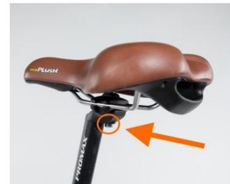
**REMARQUE :** avant la première sortie, veillez à serrer correctement le collier de tige de selle via la vis de réglage de la selle. Un collier de tige de selle ou une vis de réglage de tige de selle mal serré peut endommager le vélo ou occasionner des dégâts matériels et peut provoquer une perte de contrôle, une chute ou des blessures graves, voire mortelles. Contrôlez régulièrement si le collier de tige de selle est bien serré.
