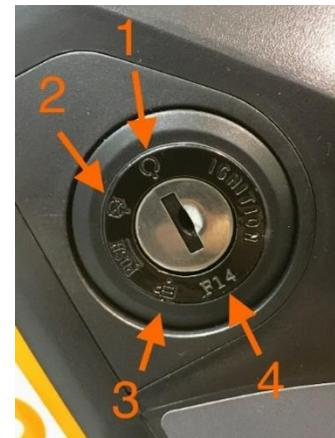
3. **Allumez le vélo.** Introduisez la clé et amenez-la dans le sens des aiguilles d'une montre sur l'icône de cercle ouvert ou sur la position "on, verrouillée" (1) comme illustré. **Retirez la clé** en tirant directement vers l'arrière sans la tordre afin que le barillet demeure sur la position "on, verrouillée". Trouvez la commande de l'écran LCD (près de la poignée gauche). Maintenez le bouton central "MODE" enfoncé pendant environ 2 secondes jusqu'à ce que l'écran LCD s'allume.
