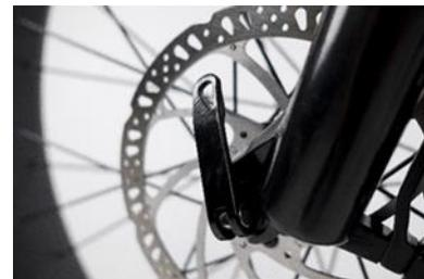
**Trouvez le levier de l'attache rapide** qui maintient la plaque de protection en place pendant le transport. Ouvrez le levier et déposez l'écrou moleté et le ressort conique (côté opposé au levier). Retirez la broche pour l'attache rapide de la plaque en maintenant la rondelle et l'autre ressort conique en place du côté du levier.
