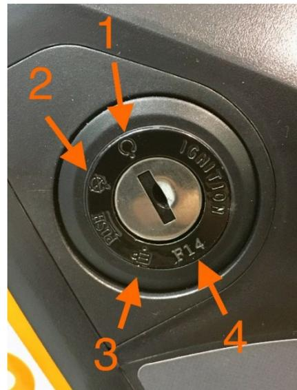
3. **Allumez le vélo.** Introduisez la clé et amenez-la dans le sens des aiguilles d'une montre sur l'icône de cercle ouvert ou sur la position "on, verrouillée" comme illustré. **Retirez la clé** en tirant directement vers l'arrière sans la tordre afin que le barillet demeure sur la position "on, verrouillée". Trouvez la commande de l'écran LCD (près de la poignée gauche). Maintenez le bouton central "mode" enfoncé pendant environ 2 secondes jusqu'à ce que l'écran LCD s'allume.
