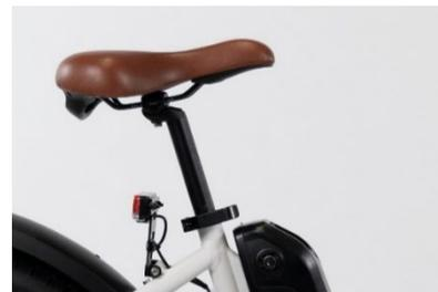
Le cas échéant, vissez l'écrou pour mettre le collier sous tension afin de créer une légère résistance lorsque le levier est aligné sur la vis du collier de serrage, mais ne serrez pas trop fort. Fermez le levier du mécanisme de serrage rapide pour fixer la tige de selle et confirmez que celle-ci ne bouge pas. Consultez la section Réglage de la selle dans ce manuel pour obtenir de plus amples informations.
