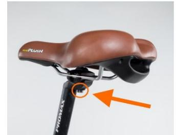
**HINWEIS:** Vergewissern Sie sich vor der ersten Fahrt, dass die Sattelklemme mit der Sattelleinstellschraube sicher festgezogen ist. Gelockerte Sattelklemmen oder Sattelleinstellschrauben können zu Schäden an Bike und/oder Eigentum, Stürzen und schweren oder tödlichen Verletzungen führen. Überprüfen Sie regelmäßig, ob die Sattelklemme ausreichend fest angezogen ist.
