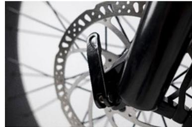
**Wenn das Gabelausfallende** sicher auf der Schnellspannerachse sitzt (und die Bremsscheibe im Bremssattel), können Sie die Flügelmutter festziehen. Sobald die Spannung hoch genug ist, um den Schnellspannerhebel in einer Linie mit der Achse zu halten, schließen Sie den Hebel mit der Hand und achte dabei darauf, die Bremsscheibe nicht zu berühren.
