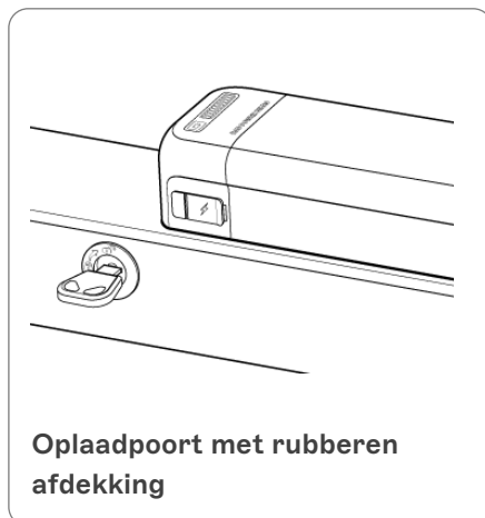
Oplaadpoort, afdekking open, met uitgangstekker van de oplader gepositioneerd om erin te steken
