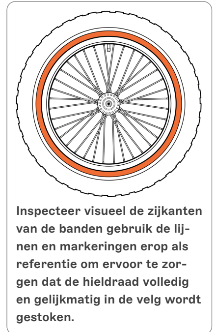
De hieldraad is het harde, afgeronde uiteinde van de band dat in de velg gaat.
