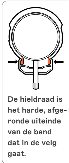
Inspecteer visueel de zijkanten van de banden gebruik de lijnen en markeringen erop als referentie om ervoor te zorgen dat de hieldraad volledig en gelijkmatig in de velg wordt gestoken.
